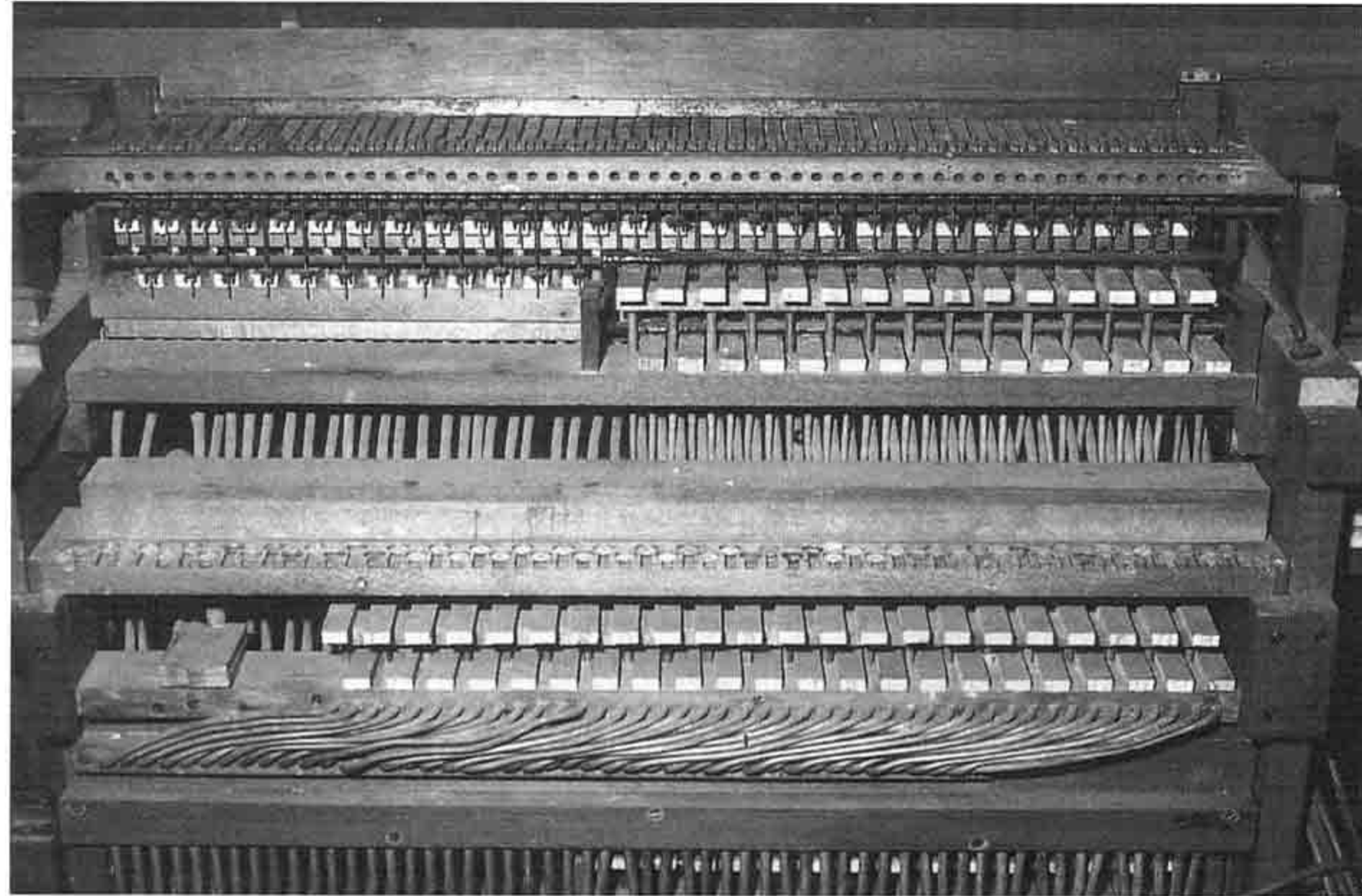
Paysandú Pneumatik im Spieltisch der Walcker-Orgel vor der Restaurierung Foto: Jürgen Rodeland
